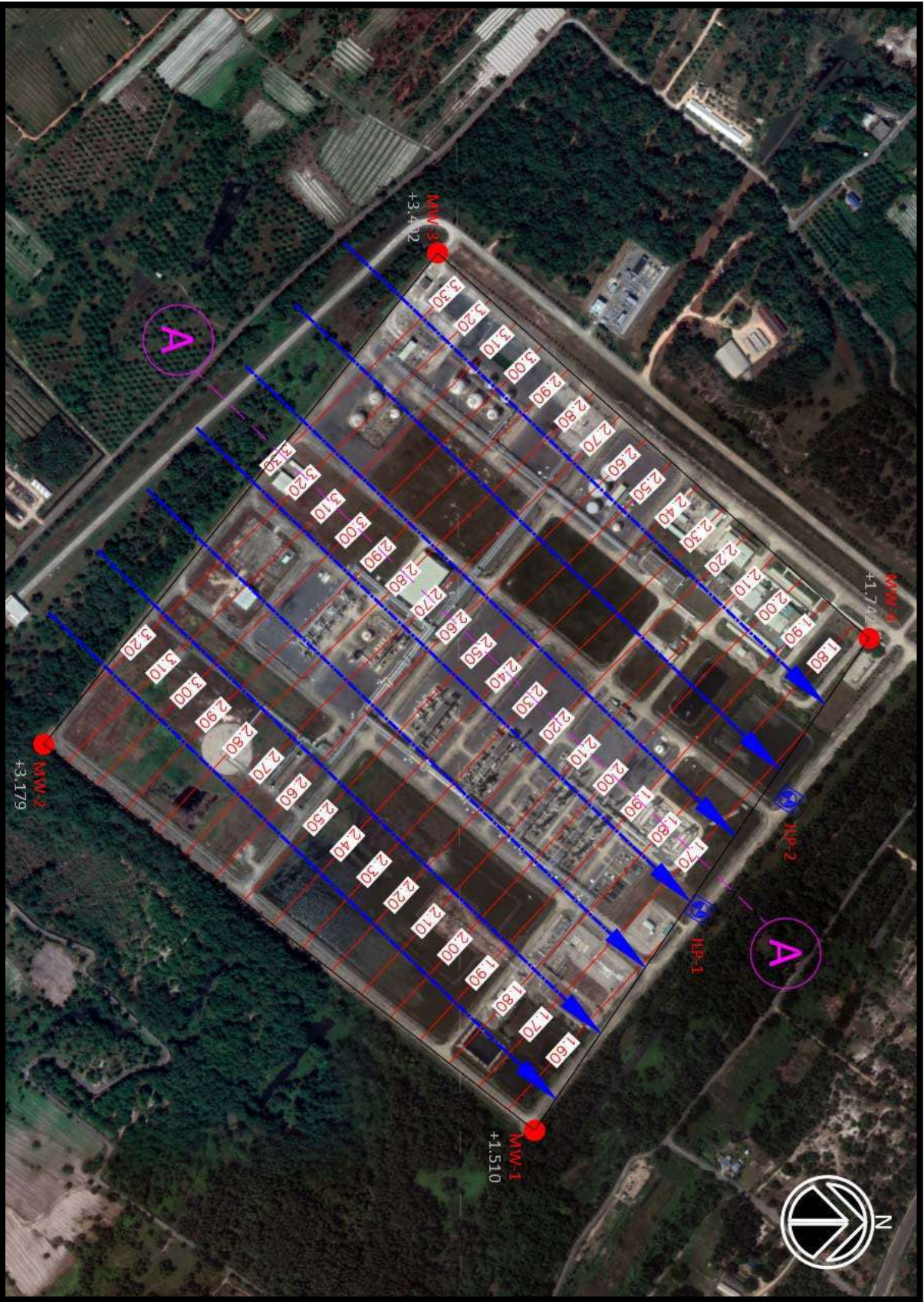
รูปที่ ผ.4 แผนที่ระดับน้ำใต้ดิน แสดง Groundwater Contours และทิศทางการไหลของน้ำภายในบริเวณพื้นที่โครงการ
